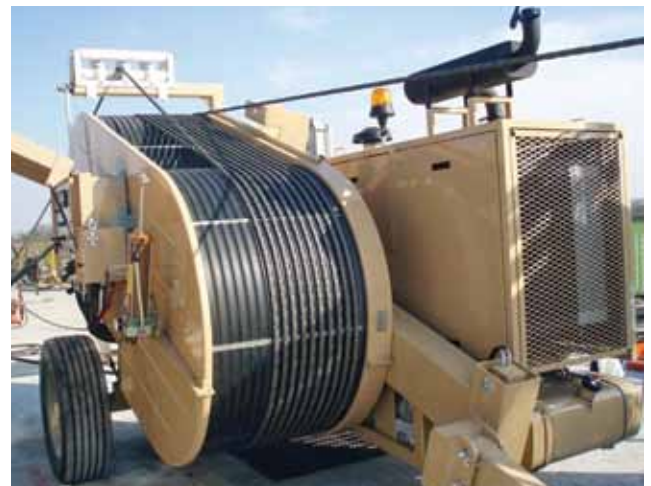
Гидравлическая натяжная-тормозная (реверсивная) машина для натяжки от одного до четырех совместных тросов или расщепленных проводов
